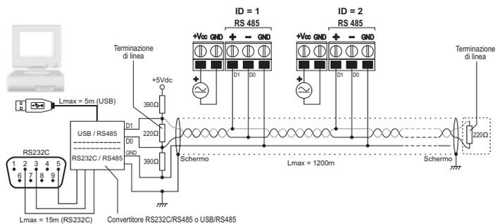
Alle due estremità della rete devono essere presenti le terminazioni di linea. Per polarizzare la linea durante i periodi di non trasmissione si usano dei resistori collegati tra le linee di segnale e l'alimentazione.
