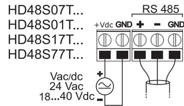
Grazie all'uscita RS485, più strumenti possono essere collegati per formare una rete. Gli strumenti sono collegati in successione mediante un cavo schermato con doppino attorcigliato per i segnali e un terzo filo per la massa.
