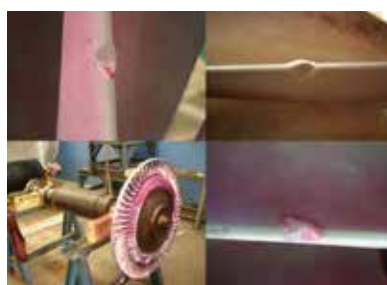
Controllo con liquidi penetranti ARW MISURE
